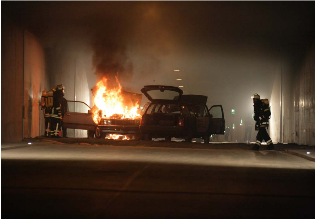
Bild 28: Brandzustand nach 8 Minuten, Rauchschichtdicke nimmt stark zu, von Osten gesehen.
