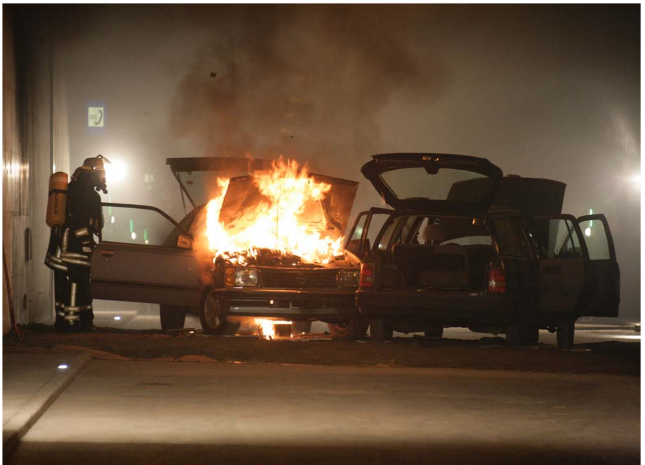
Bild 27: Brandentwicklung nach 6 Minuten, Deckenleuchten völlig verdunkelt, von Osten gesehen.
