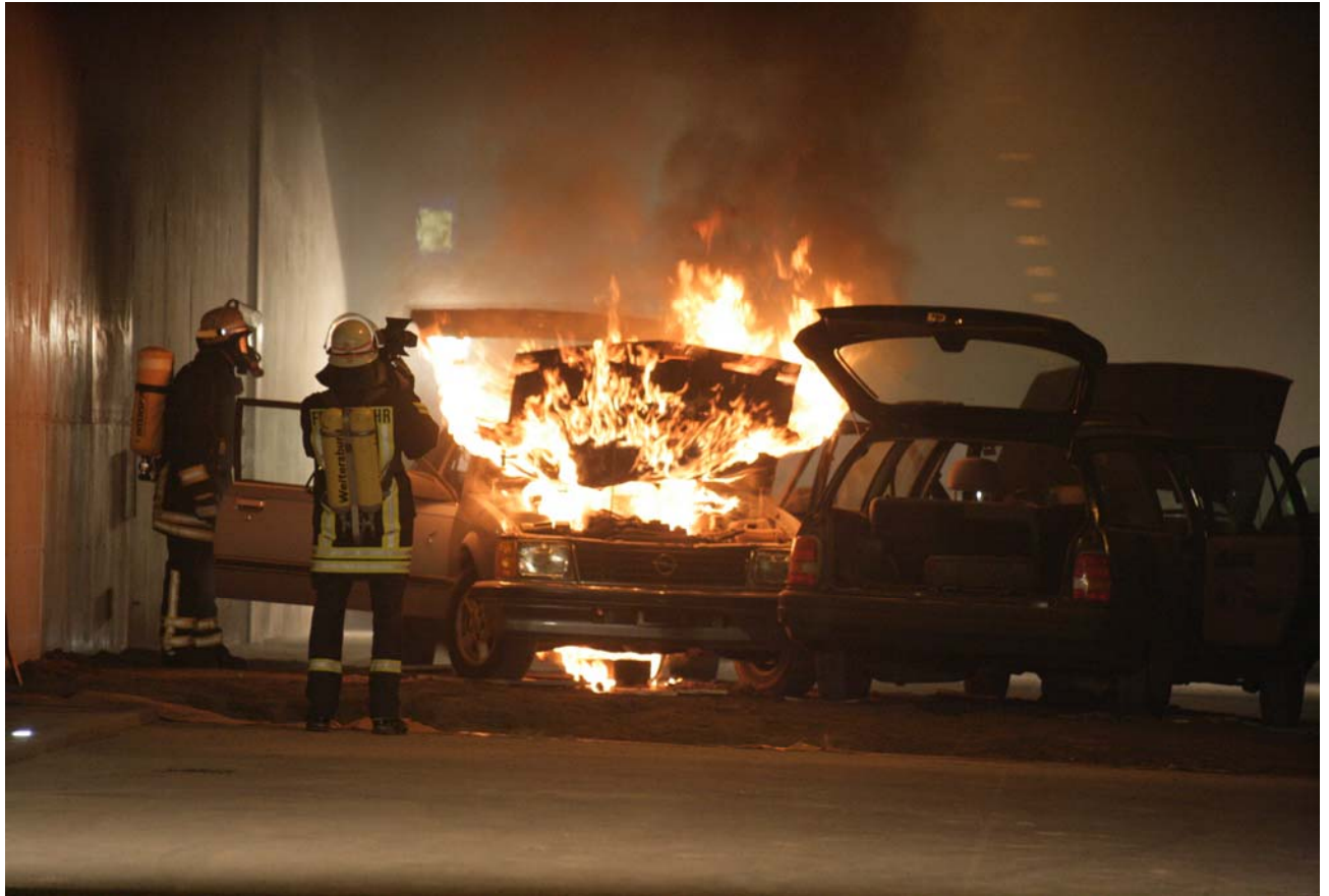
Bild 26: Brandentwicklung nach 5 Minuten, Deckenleuchten stark eingetrübt, von Osten gesehen.
