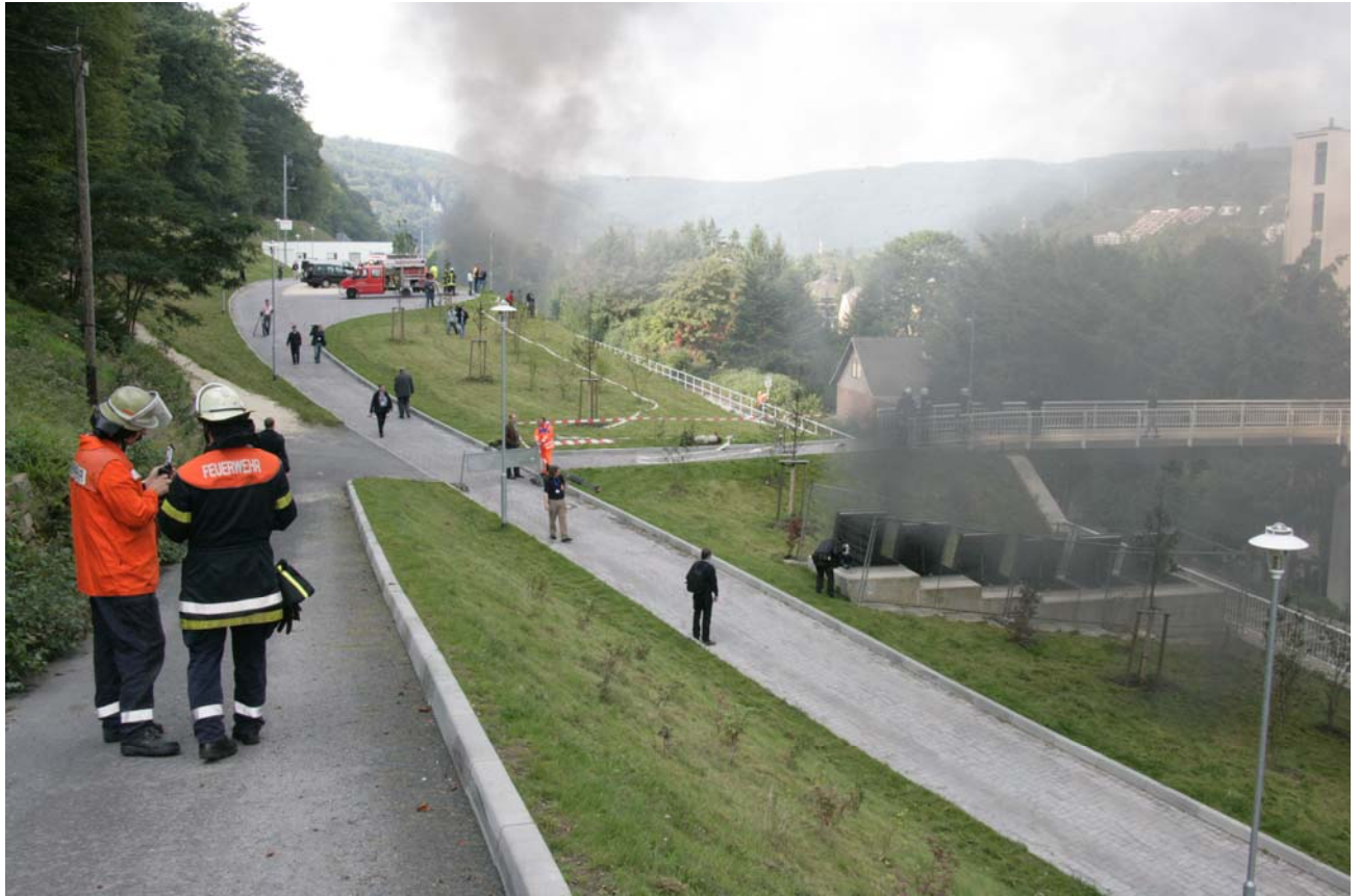
Bild 33: Rauchausbreitung bei leichtem Westwind an den Entrauchungsstationen Nr. 05 und Nr. 06, die dem Brandort am nächsten sind, nach 22 Minuten von Osten gesehen.
