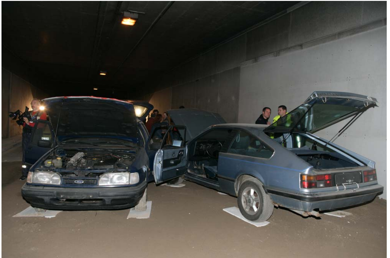
Bild 20: Ford Sierra Kombi mit 30 Ltr. Diesel und Opel Monza mit 30 Ltr. Benzin, jeweils mit 2 Reservereifen (Font und Kofferraum), geöffneten Türen u. Hauben, auf 25 mm Brandschutzplatten.
