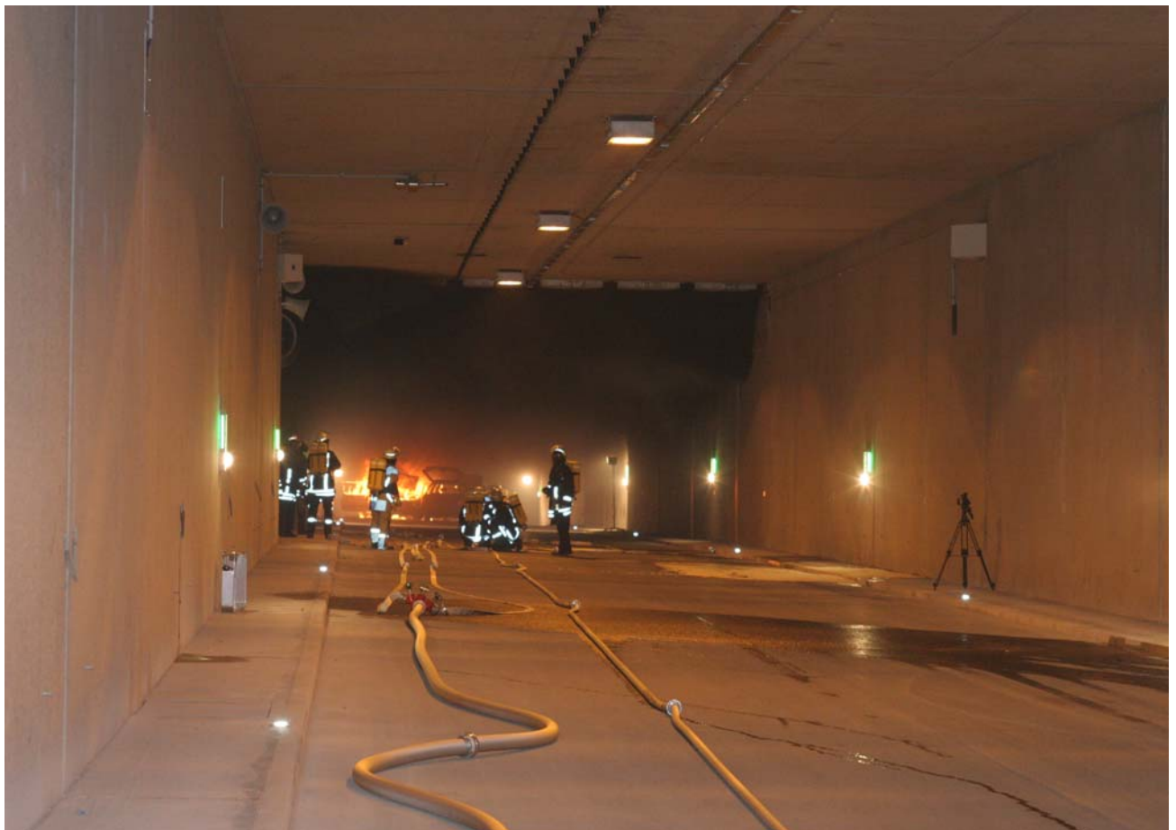
Bild 31: Brandübersprung auf das zweite Fahrzeug, bei stabiler Rauchsichtströmung zur Entrauchungsstation Nr. 06, mit Messgeräten an der Decke und Wand, nach 25 Minuten von Osten gesehen.
