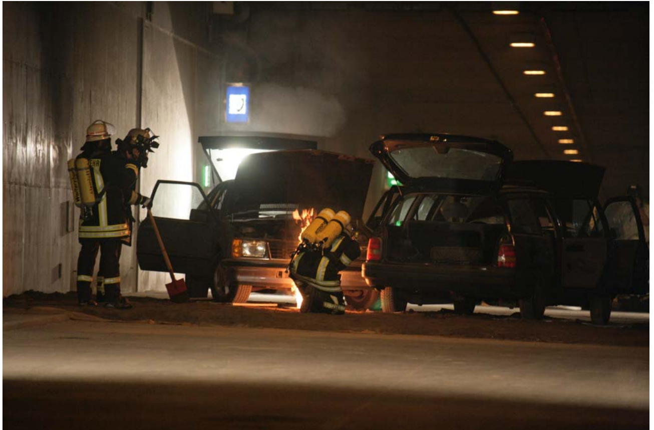
Bild 24: Zündung der Benzinwanne (mit einer Fackel) um 11:34:00 Uhr, als Stützfeuer unterm Motor, mit erster leichter Rauchentwicklung, von Osten gesehen.
