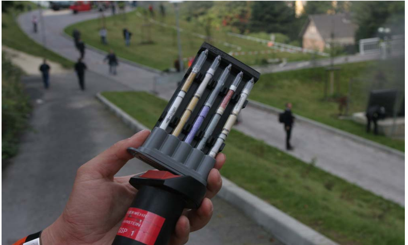
Bild 39: Prüfröhrchen mit Ansaugpumpe zur Kontrolle der Schadgasausbreitung im Freien.
