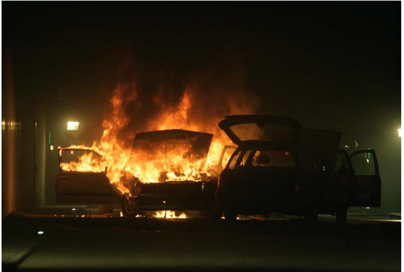
Bild 30: Vollbrand im ersten Fahrzeug, Rauchsicht stabil, nach 12 Minuten von Osten gesehen.
