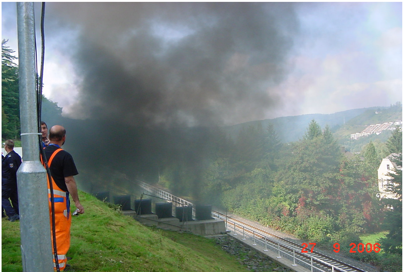
Bild 36: Rauchausbreitung an der Entrauchungsstation Nr. 05, nach 28 Minuten von Osten gesehen.
