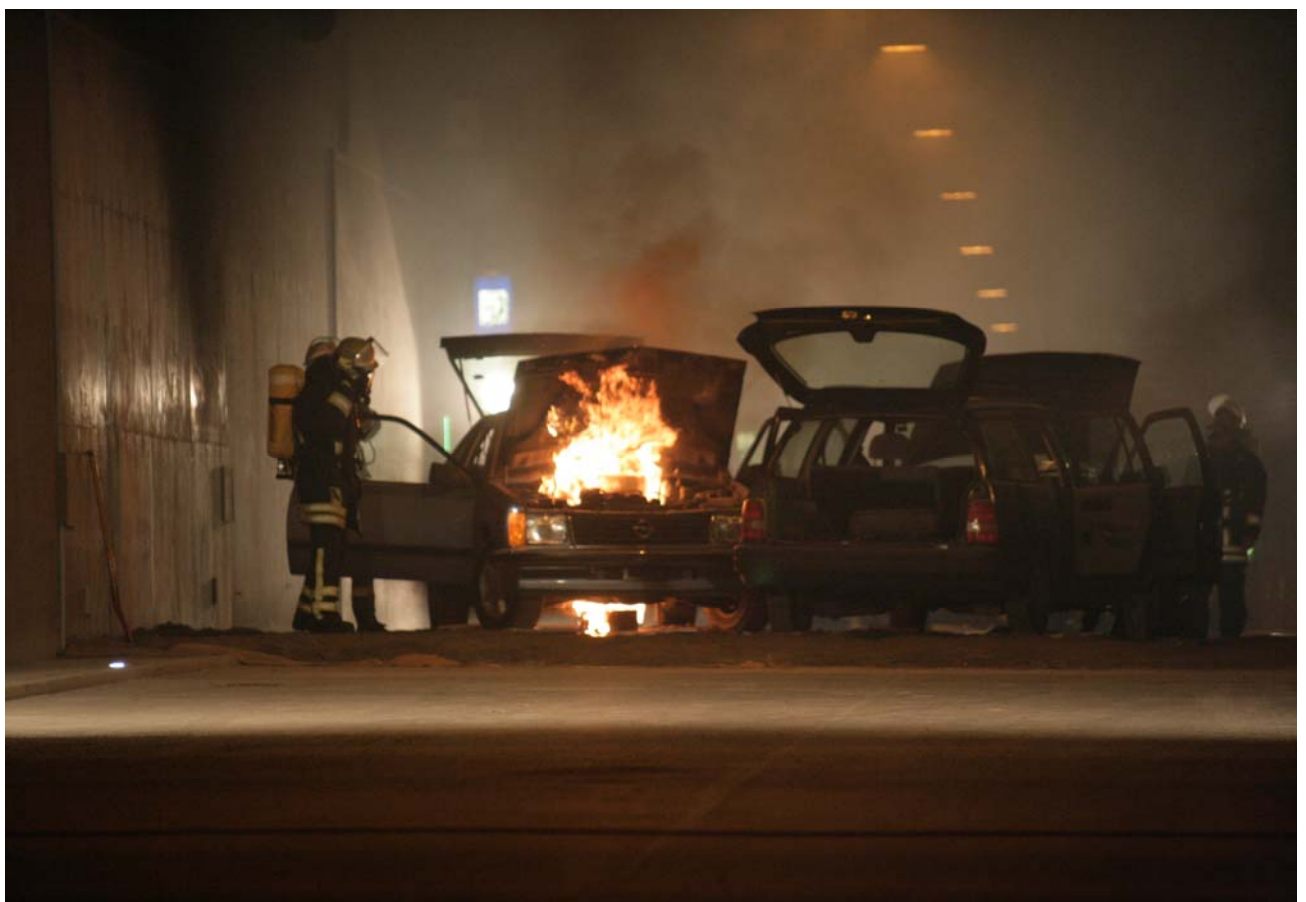
Bild 25: Brandentwicklung im Motorraum (Autobatterien wurden vorher ausgebaut) 4 Minuten nach der Zündung, mit leichter Eintrübung der Deckenleuchten, von Osten gesehen.
