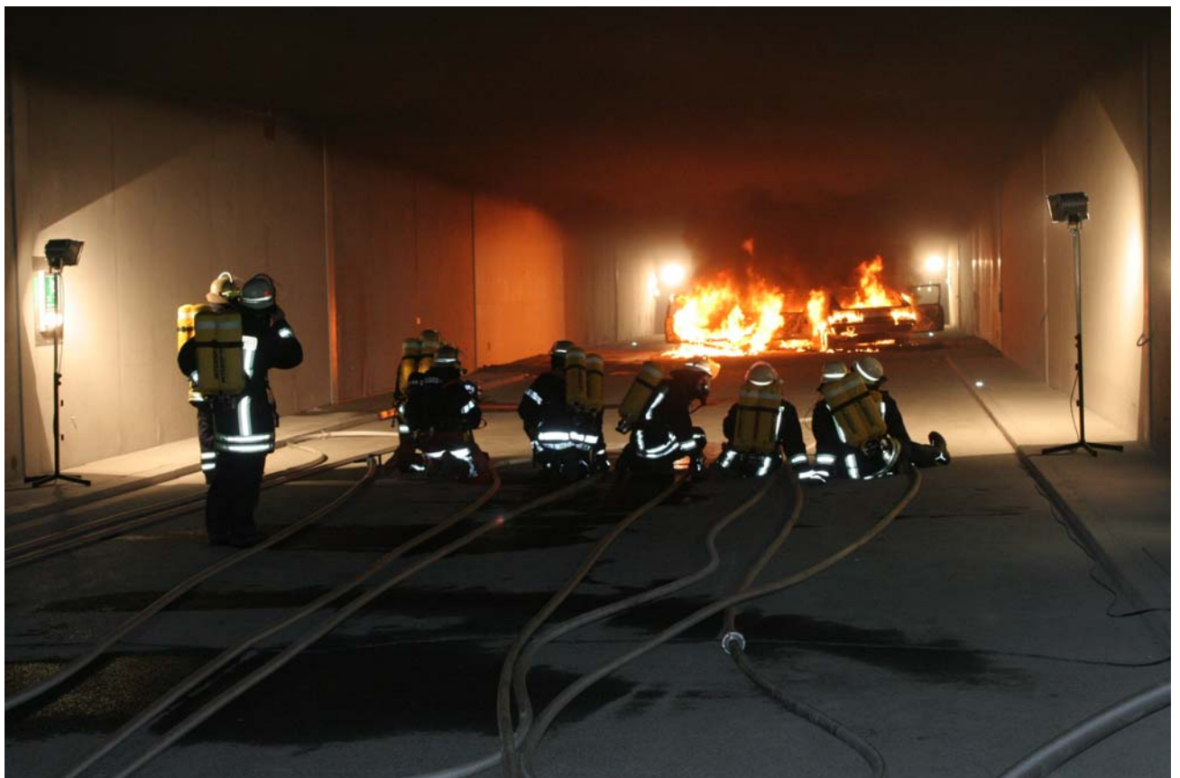
Bild 44: Beide Pkw in Brand, bei stabiler Rauchschiebtströmung, Einsatzkräfte in ca. 20 m Abstand vom Brandherd bereiten sich auf ihren Löschangriff vor, nach 27 Minuten von Westen gesehen.
