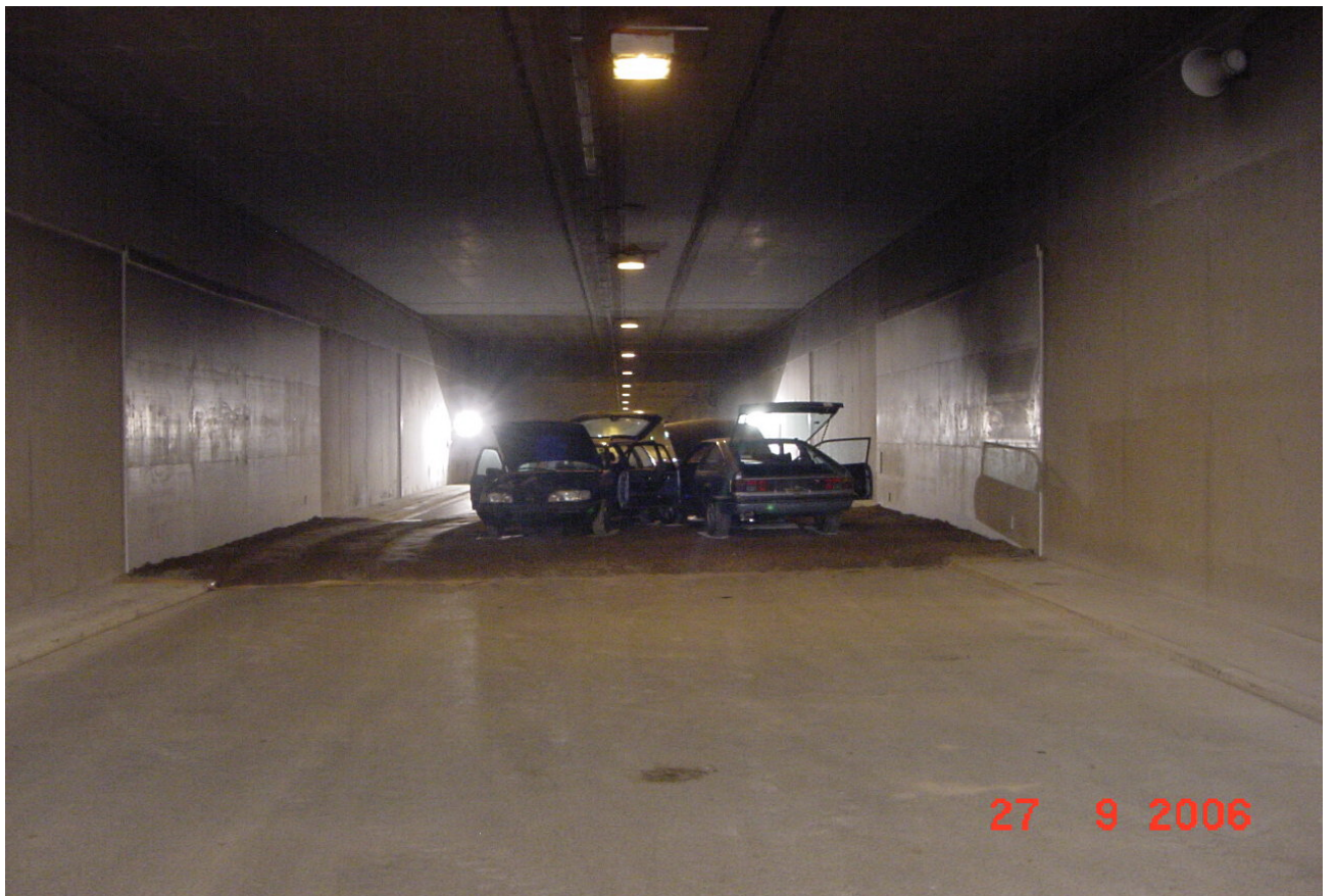
Bild 21: Aufstellung der 2 Pkw im Block 61 (km 3+100), Wände mit 5 m hoher und 10 m langer Verkleidung aus 25 mm dicken Brandschutzplatten und 1 m hohen und 100 m langen Wandstreifen.
