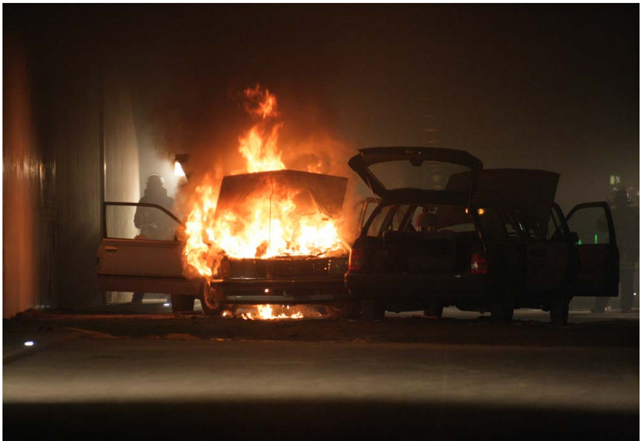
Bild 29: Brandzustand nach 10 Minuten, Rauchschicht stabil, verdunkelt alles, von Osten gesehen.
