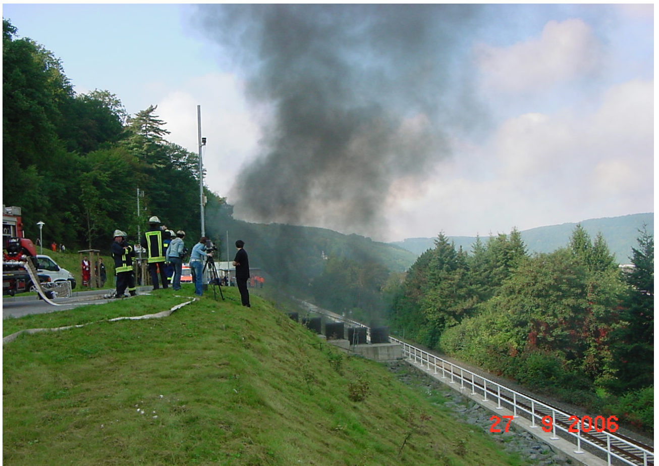
Bild 34: Rauchausbreitung an der Entrauchungsstation Nr. 05, nach 23 Minuten von Osten gesehen.
