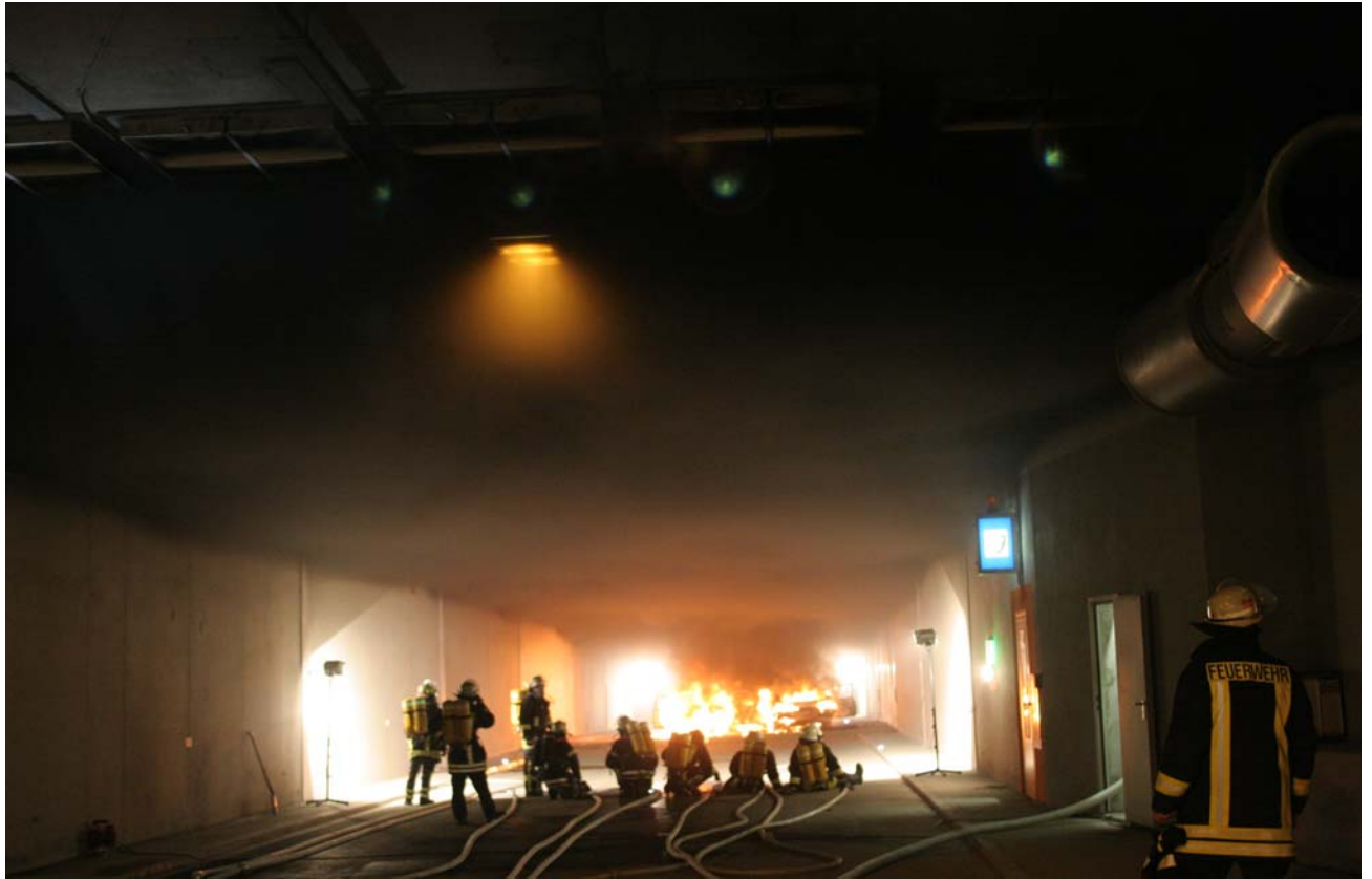
Bild 45: Beide Pkw in Brand, stabile Rauchschiebtströmung, Einsatzkräfte nehmen die Spritzen zur Hand, Löschwasserversorgung durch einen B-Schlauch aus der Hydrantennische (Versorgung von der zentralen Druckerhöhungsanlage beim Betriebsgebäude), nach 28 Minuten von Westen gesehen.
