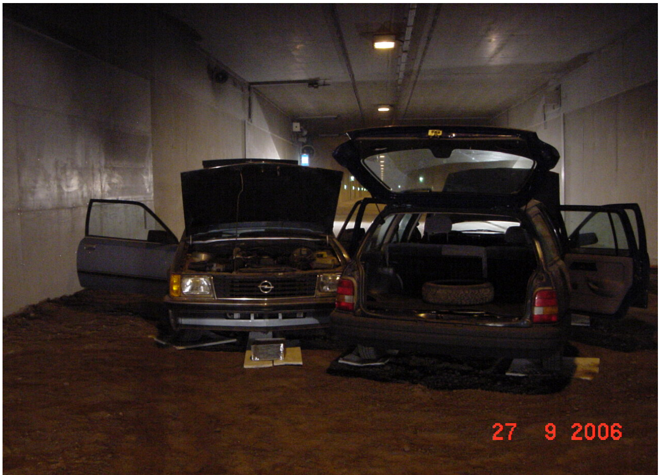
Bild 23: Lage der Zündwanne (mit 5 Ltr. Benzin) unter dem Benzinmotor im 10 cm hohen Sandbett (feuchter Kabelsand), von Osten gesehen (mit Messgeräte an der Decke in 20 m bis 30 m Abstand).
