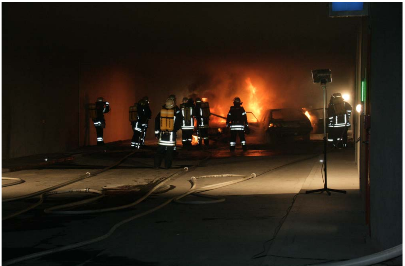
Bild 48: Beginn des Löscheinsatzes nach 28 Minuten von Westen (Beendigung nach einer weiteren Minute). Die stabile Schichtströmung blieb über die gesamte Brandzeit und Löschzeit immer erhalten.
