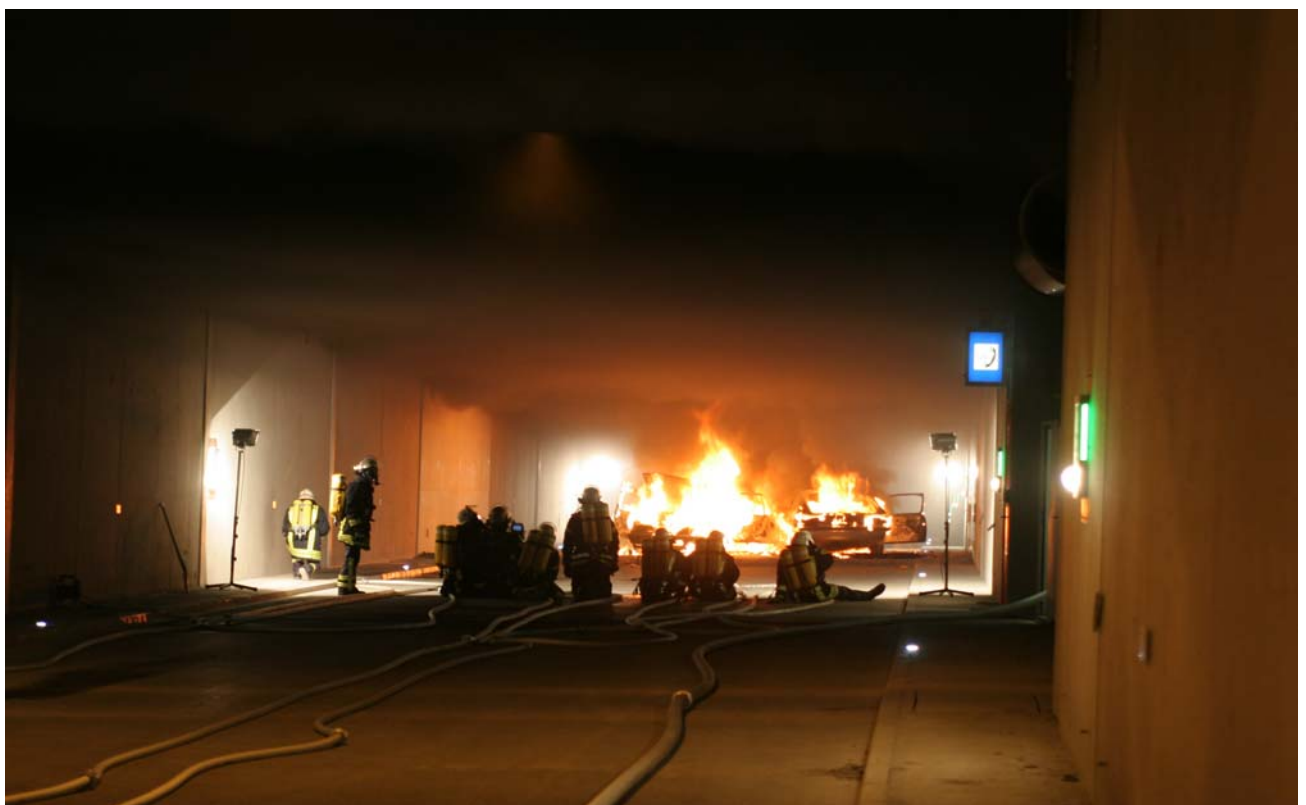
Bild 42: Beide Pkw im Vollbrand (12 MW) bei stabiler Rauchschichtströmung, Einsatzkräfte mit Wärmebildkamera, PA und C-Schläuchen in Bereitschaft, nach 24 Minuten von Westen gesehen.
